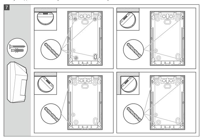
5. Закрепите основание корпуса на стене (рис. 7) или на кронштейне, закрепленном на стене или потолке (рис. 8). Комплектные распорные дюбели предназначены для монтажных поверхностей таких как бетон, кирпич и т. д. В случае другой монтажной поверхности (гипс, пенопласт), используйте другие соответствующие дюбели.
