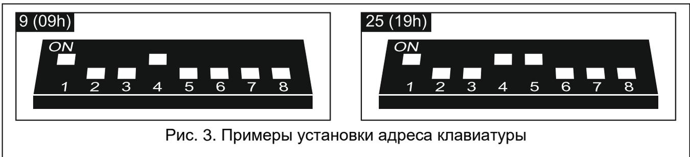
Рис. 3. Примеры установки адреса клавиатуры
