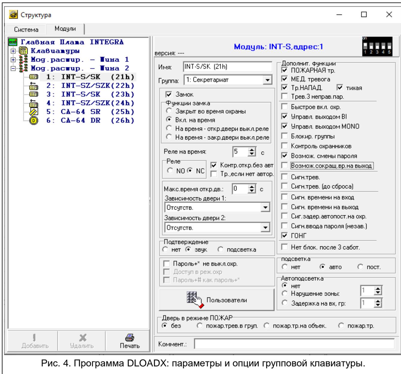
Рис. 4. Программа DLOADX: параметры и опции групповой клавиатуры.
