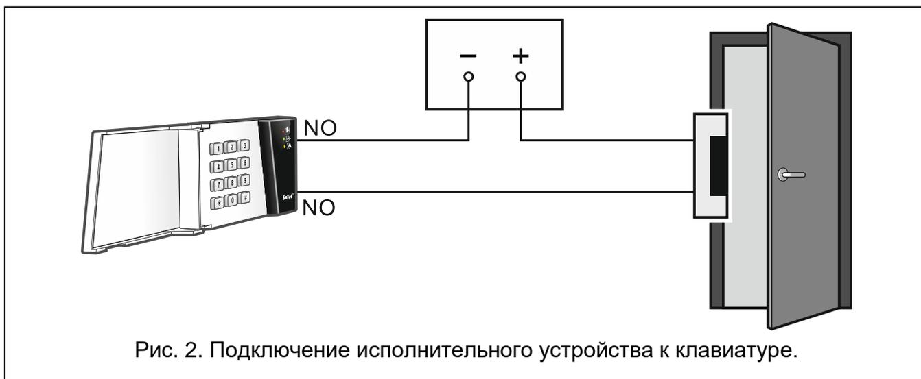
Рис. 2. Подключение исполнительного устройства к клавиатуре.
