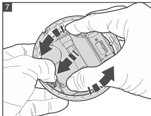
5. Nehmen Sie das Elektronikmodul mit der Rauchkammer heraus (Abb. 8).
