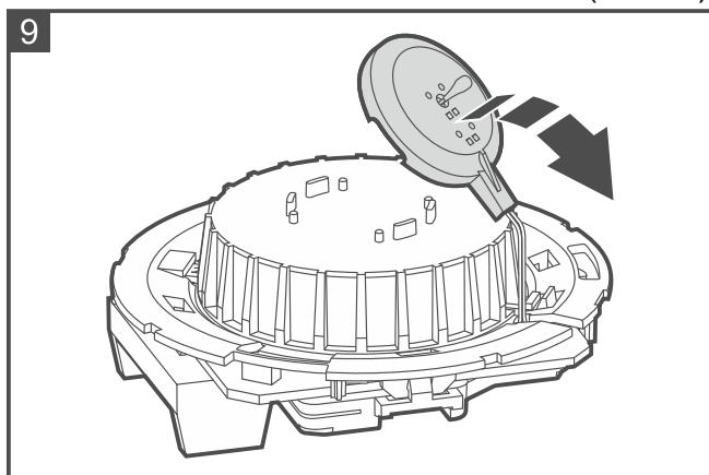
7. Ziehen Sie den Haken ab (Abb. 10) und nehmen Sie den Deckel der Rauchkammer ab (Abb. 11).
