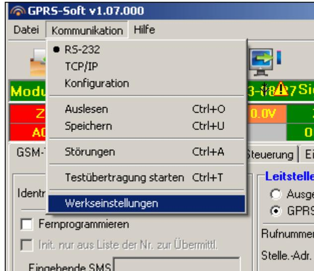
Abb. 16. Funktion „Werkseinstellungen“ im Menü „Kommunikation“.
