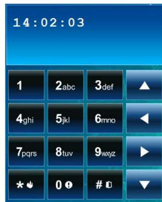
Das Tastaturfeld ermöglicht die Bedienung und Parametrierung des Alarmsystems genauso wie über ein LCD-Bedienteil mit dem Textmenü. In den Parametrierungs- und Benutzeranleitungen der Alarmzentrale wurde beschrieben, wie solch ein Bedienteil verwendet werden soll (die Anleitungen finden Sie auf unserer Webseite [www.satel.eu](http://www.satel.eu)).
