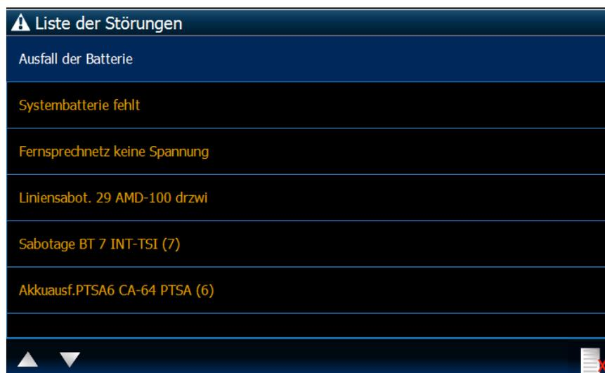
Es werden laufende Störungen angezeigt. Der Errichter kann die Zentrale so konfigurieren, dass die Störungen bis zur Löschung vom Benutzer angezeigt werden. Um den Störungsspeicher zu löschen, tippen Sie auf die Taste
