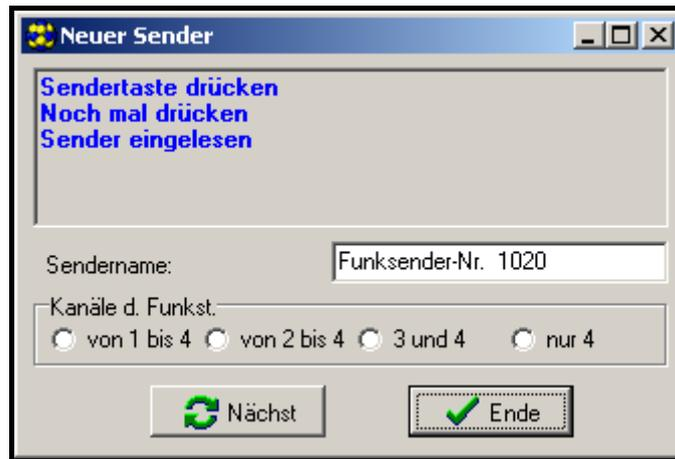
Abb. 3. Fenster für Hinzufügung neuer Handsender im DLOAD10 Programm.
