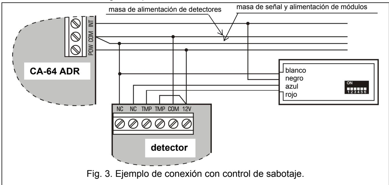
**Nota:** La selección de la línea tipo EOL es interpretada por la central como conexión del detector tipo NC sin control de sabotaje.
