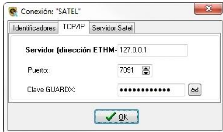
Fig. 22. Programa GUARDX: pestaña «TCP/IP» en la ventana «Conexión».
