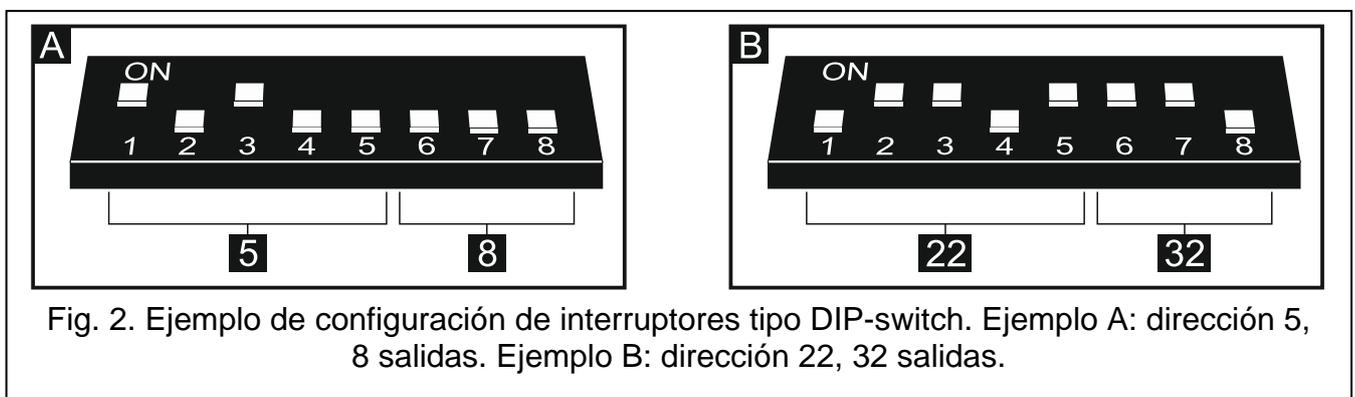
Fig. 2. Ejemplo de configuración de interruptores tipo DIP-switch. Ejemplo A: dirección 5, 8 salidas. Ejemplo B: dirección 22, 32 salidas.
