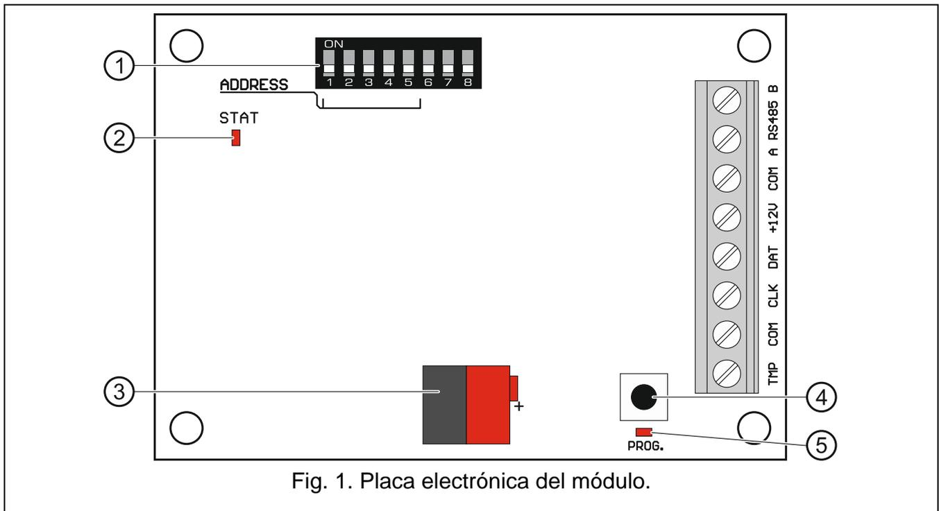
Fig. 1. Placa electrónica del módulo.
