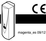
El detector MAGENTA posibilita detectar los sonidos del cristal al romperse, sea este cristal de tipo normal, laminado o templado. El detector indicará una alarma después de que registre un sonido de baja frecuencia (impacto) seguido por un sonido de alta frecuencia (rotura de cristal). El canal de alta frecuencia se analizará durante 4 segundos desde el momento de que el detector reciba una onda de sonora de baja frecuencia.
