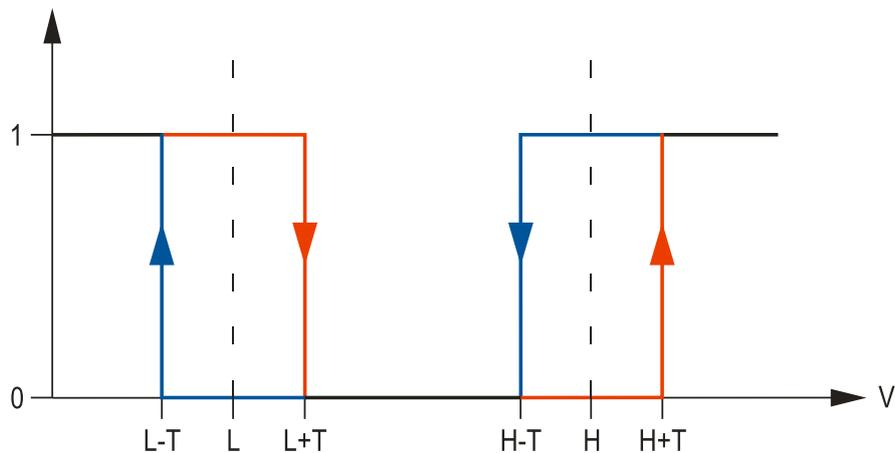
Fig. 10. Modo de operativa de las zonas analógicas. 0 – falta violación. 1 – violación. L-T - nivel de voltaje L menos la tolerancia. L – nivel inferior de voltaje. L+T – nivel de voltaje L más la tolerancia. H-T – nivel de voltaje H menos la tolerancia. H – nivel superior de voltaje. H+T – nivel de voltaje H más la tolerancia.
