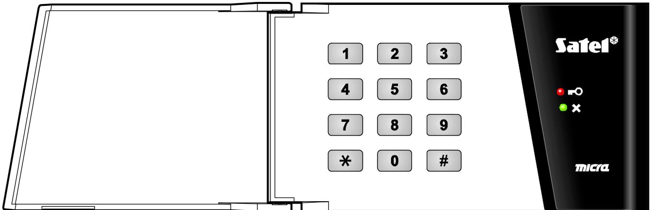
Después de realizar las operaciones determinadas en el teclado (ver: apartado GESTIÓN DE SISTEMA DE ALARMA) los comandos se envían vía radio al módulo MICRA.
