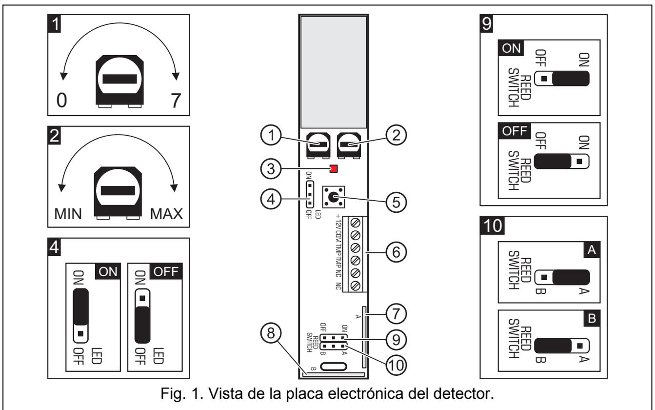
Fig. 1. Vista de la placa electrónica del detector.
