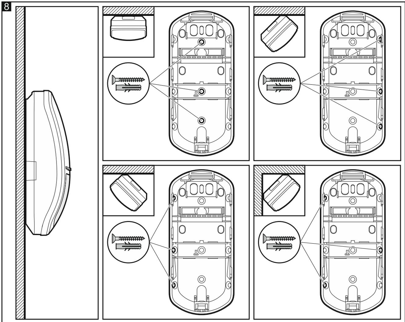
13. Fixez l'embase du boîtier au mur (fig. 8). Les chevilles fournies sont destinées à la surface de montage de type béton ou brique, etc. Pour une autre surface (gypse, polystyrène, etc.), utilisez des chevilles bien adaptées.
