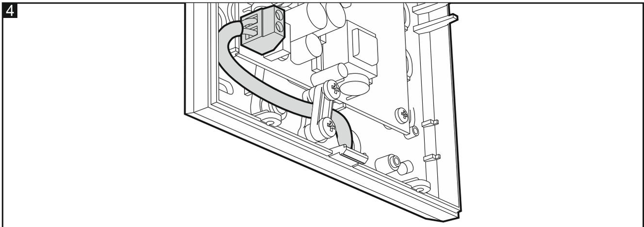
15. Branchez la batterie au connecteur (le retransmetteur ne démarre pas si seule la batterie est connectée).
