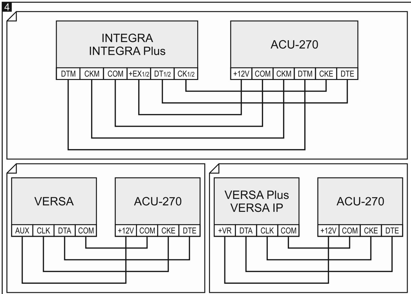
Для подключения следует использовать простой неэкранированный кабель. В случае использования кабеля типа «витая пара» следует помнить, что сигналы СКМ и DTM / СКЕ и DTE (clock и data) не должны передаваться одной витой парой проводов. Провода должны подводиться в одном кабеле. Кабельная проводка должна быть защищена от прикосновения к острым краям, так как это может привести к ее повреждению.
