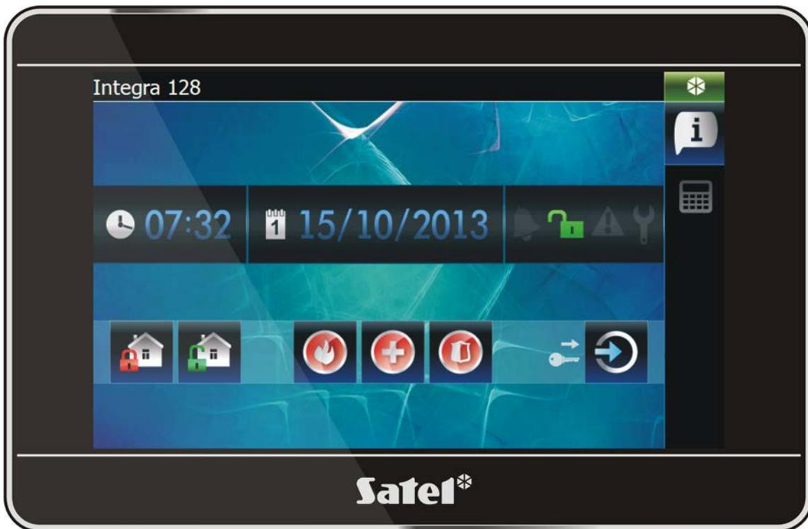
На экране клавиатуры отображается графический интерфейс, позволяющий пользователю управлять системой охранной сигнализации и домашней автоматикой. Во время настройки установщик создает шаблоны, которые определяют, как должен выглядеть интерфейс и какие функции должны быть предоставлены пользователям. Интерфейс может быть индивидуально настроен для каждого пользователя, а также отличаться в зависимости от того, авторизован ли пользователь или нет.
