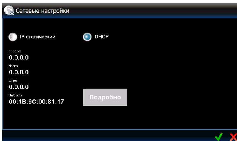
**Статический IP** – в случае включения этой опции, сетевые установки клавиатуры необходимо запрограммировать (прикоснитесь к одному из нижеследующих параметров и с помощью появившейся клавиатуры, введите данные).
