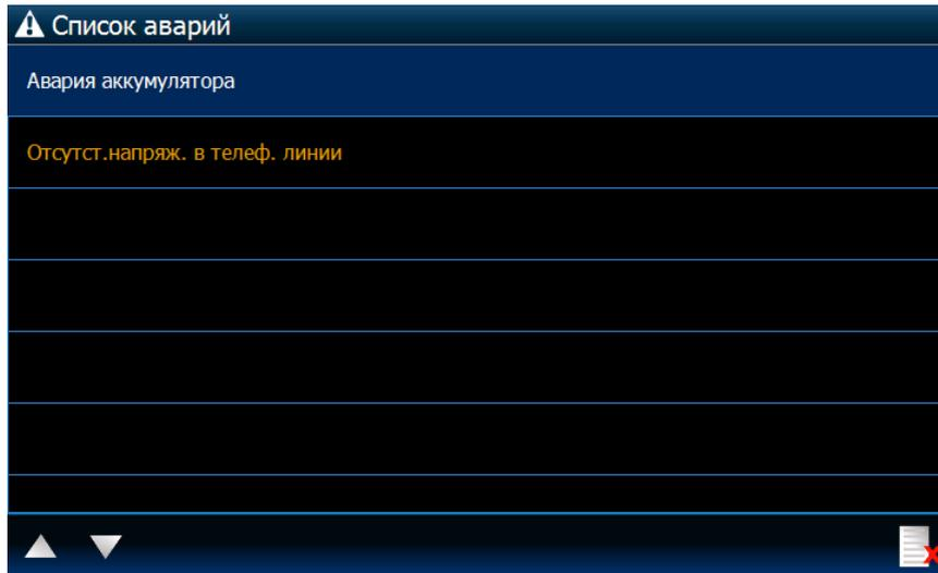
Отображение списка текущих аварий. Установщик может настроить прибор таким образом, чтобы аварии отображались до их удаления пользователем. Нажмите
