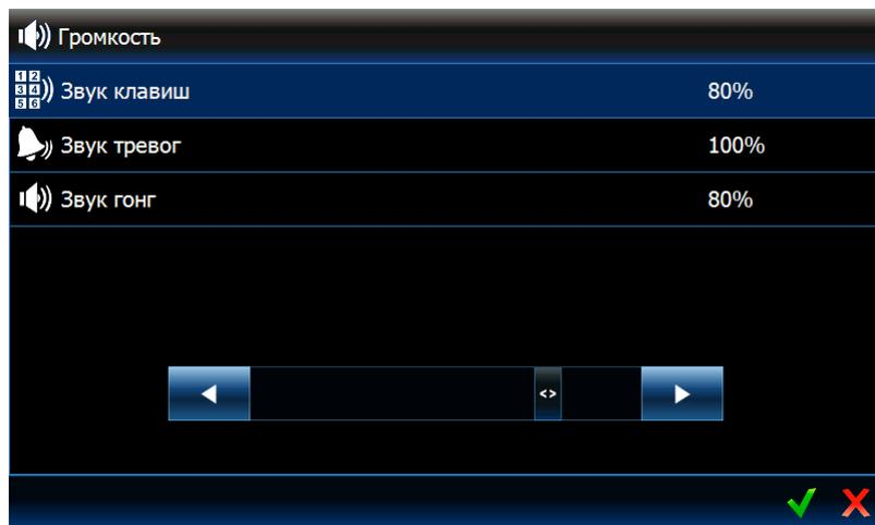
Уровень громкости клавиатуры может отличаться в зависимости от типа генерируемых звуков. Прикоснитесь к одной из позиций в списке, чтобы выделить ее, и определите громкость с помощью ползунка.
