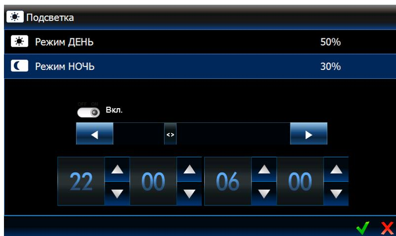
Подсветка дисплея регулируется. Может быть разной в зависимости от времени суток. Яркость настраивается с помощью ползунка. Если должен использоваться ночной режим, включите соответствующую опцию, затем определите соответствующий период времени.
