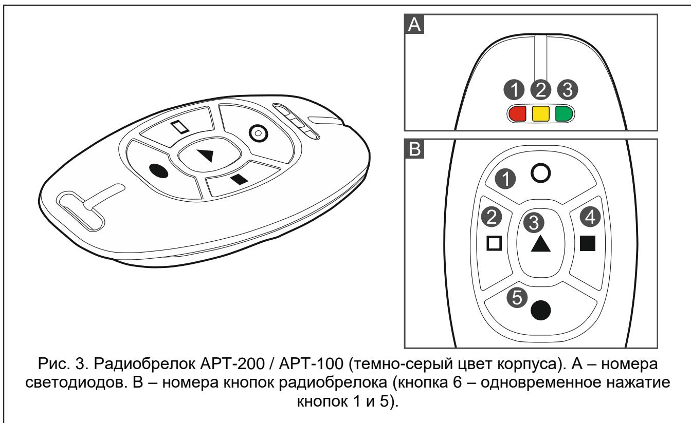
Рис. 3. Радиобрелок АРТ-200 / АРТ-100 (темно-серый цвет корпуса). А – номера светодиодов. В – номера кнопок радиобрелока (кнопка 6 – одновременное нажатие кнопок 1 и 5).
