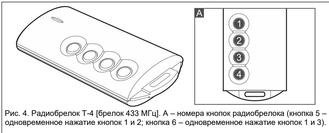
Рис. 4. Радиобрелок Т-4 [брелок 433 МГц]. А – номера кнопок радиобрелока (кнопка 5 – одновременное нажатие кнопок 1 и 2; кнопка 6 – одновременное нажатие кнопок 1 и 3).
