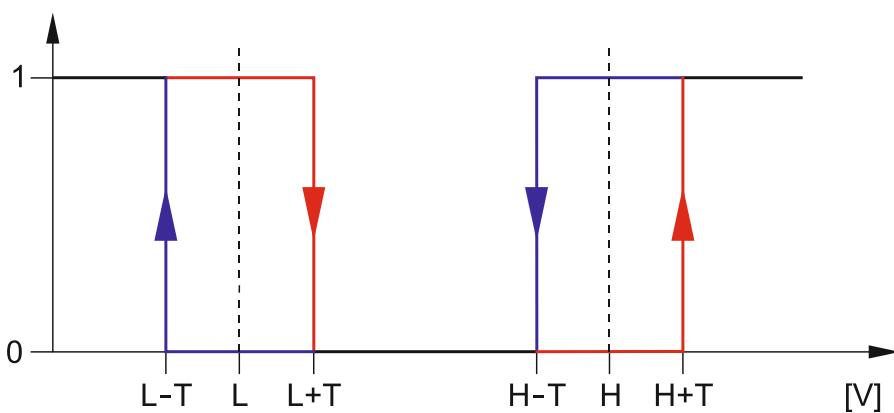
Obr. 20. Spôsob činnosti analógového vstupu. 0 – normálny stav (bez narušenia), 1 – prah prekročený (narušenie),  $L-T$  - dolný prah minus tolerancia,  $L$  – dolný prah,  $L+T$  – dolný prah plus tolerancia,  $H-T$  – horný prah minus tolerancia,  $H$  – horný prah,  $H+T$  – horný prah plus tolerancia.
