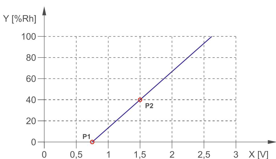
Obr. 21. Príklad lineárnej charakteristiky detektora vlhkosti ovzdušia.
