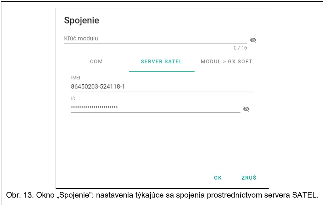
Obr. 13. Okno „Spojenie”: nastavenia týkajúce sa spojenia prostredníctvom servera SATEL.
