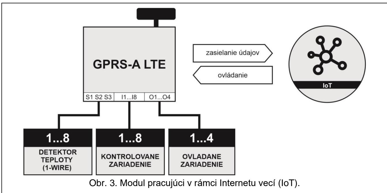
Cez mobilnú sieť (TCP) môže modul komunikovať so zariadeniami v internete vecí (Internet of Things – IoT). Umožňuje to integráciu modulu napr. so systémami automatiky a zberu údajov merania. Modul môže zasielat do zariadení v IoT informácie o stave vstupov a výstupov a hodnoty z analógových vstupov a zo zbernice 1-Wire. Ako odpoveď môže modul prijímať príkazy na zablokovanie / odblokovanie vstupov a na spustenie / vypnutie výstupov modulu.
